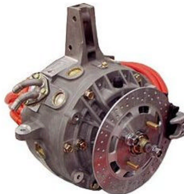
cliché 3 : prototype de moteur électrique directement couplé à une roue motrice ; un tel moteur, compact, robuste et puissant, pourra équiper les quatre roues du véhicule.
