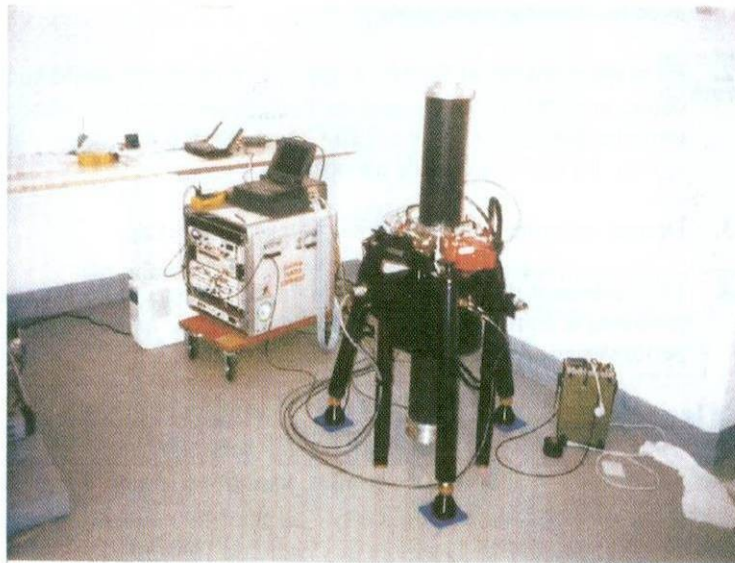
figure 15 : Gravimètre à chute type FG-5 de l'observatoire gravimétrique de Strasbourg
