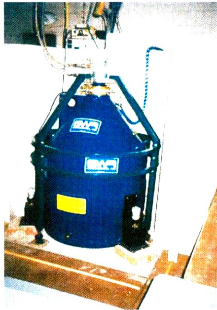
figure 12 : Gravimètre supraconducteur de l'observatoire gravimétrique de Strasbourg
